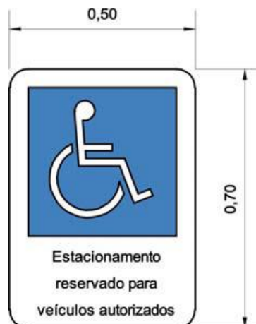
Figura 35 – Sinalização vertical em espaço interno
