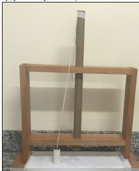
Figura 17. Equipamento para indução da lesão muscular traumática.
