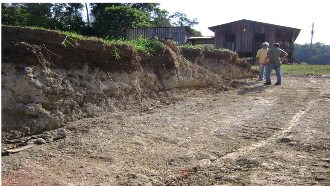
Figura 13 – Pacote argiloso de coloração esbranquiçada explorado para a fabricação de cerâmica vermelha.
