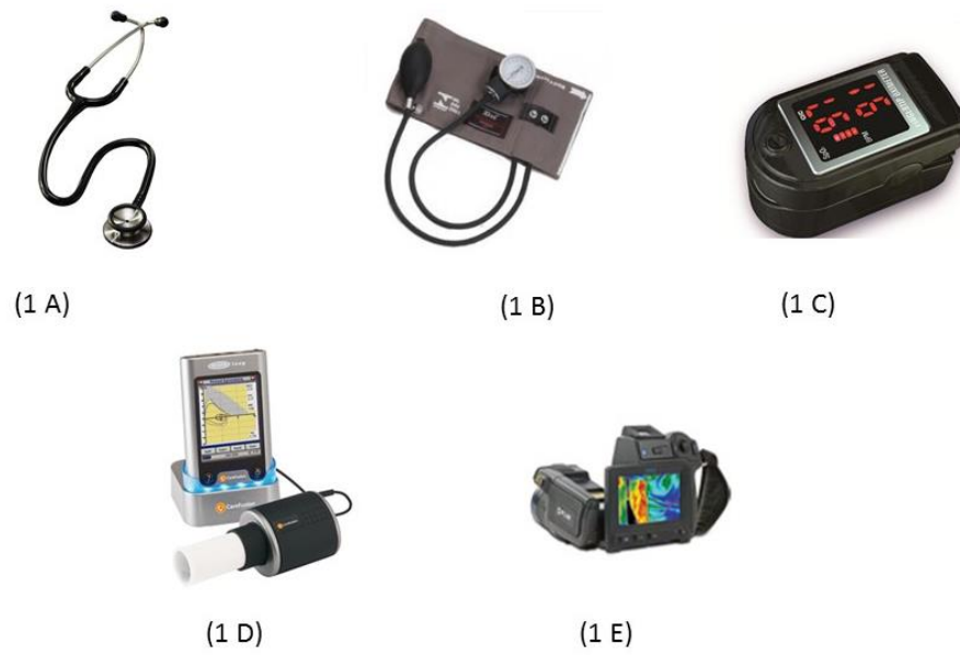
Figura 5 – Instrumentos utilizados nas avaliações realizadas na pesquisa (1A. Estetoscópio (Littman, EUA); 1B. Esfigmomanômetro (BIC, BRA); 1C. Oxímetro de pulso (Contec MS Ltd, model CMS-50L, EUA); 1 D. do espirômetro portátil MicroLoop™ Spirometer (CareFusion, EUA); 1E. Câmera ThermoCAM T450sc (FLIR/EUA).
