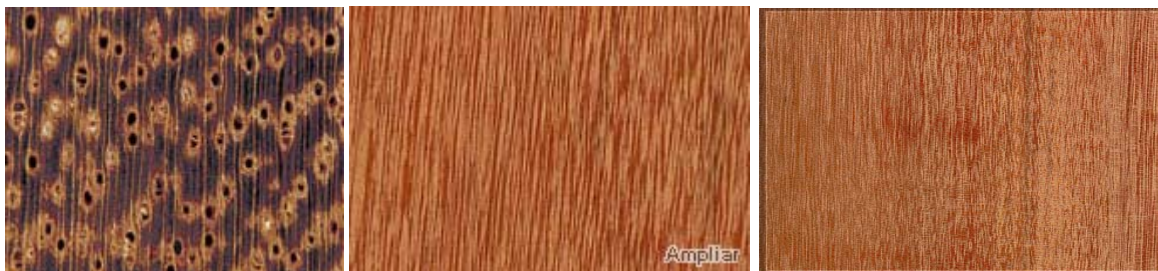
Figura 10- Fotomacrografia (10x)(a), Corte Tangenciais (b) e Radiais (c) no cerne da madeira Mandioqueira
