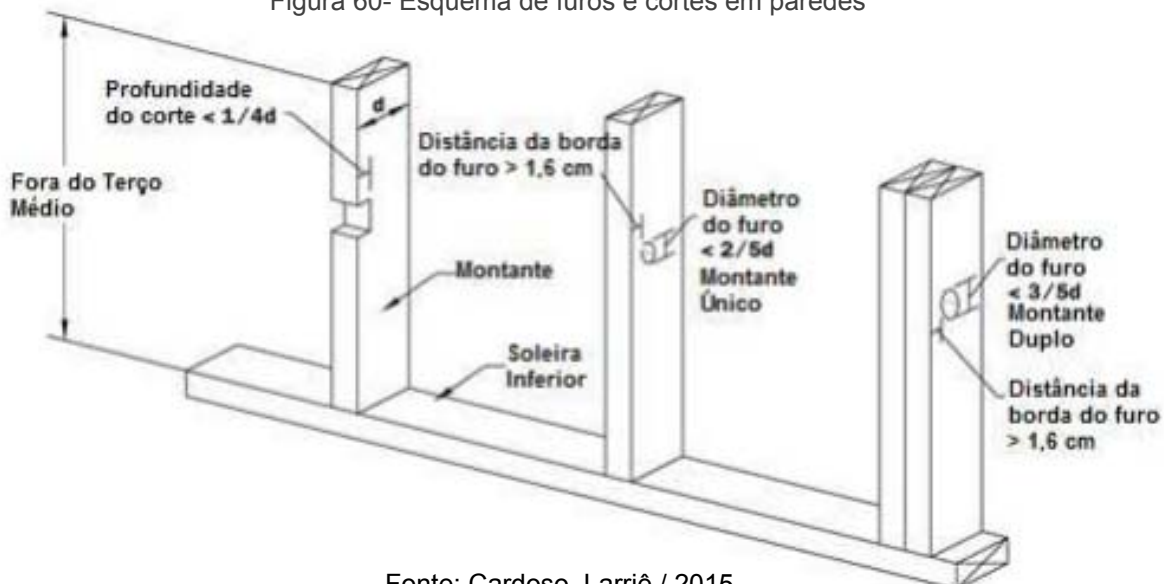
Figura 60- Esquema de furos e cortes em paredes
