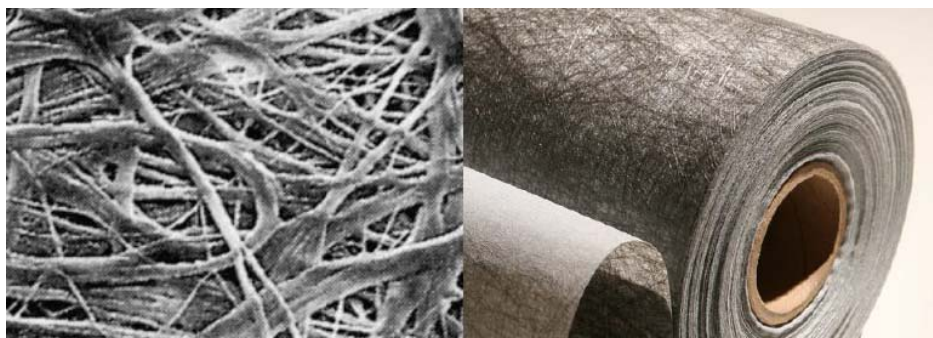
Figura 25 - Membrana Impermeável a água e permeável ao vapor
