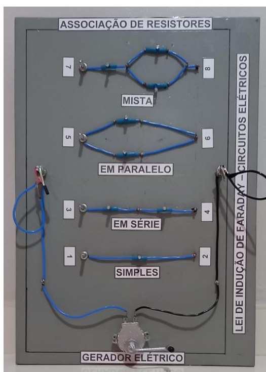
Figura 07 – Proposta experimental vista de cima. São quatro possíveis tipos de circuitos. Simples, em série, em paralelo e mista. Fonte: elaborado pelo autor.
