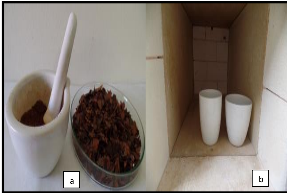
Figura 10 - Amostra de folhas de F. chica secas e pulverizadas (a) e da calcinação em forno mufla (b) para obtenção de cinzas
