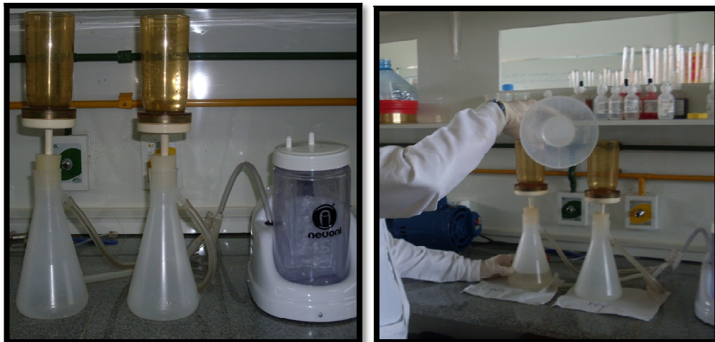
Fotografia 11: Filtração das amostras por meio de uma bomba a vácuo
